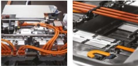
Durante l'assemblaggio di componenti esposti ad alta tensione come sbarre e cabling, l'utilizzo di strumenti isolati è uno dei tanti passaggi importanti per proteggere da scosse elettriche e danni:
