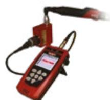
■ Routine di **taratura del trasduttore** dell'utensile
