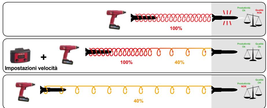
**Due impostazioni di velocità facilmente controllabili da un modulo esterno**
