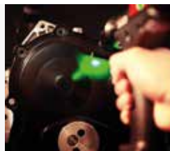
Farbe der Schraubstellenbeleuchtung abhängig vom Schraubergebnis
