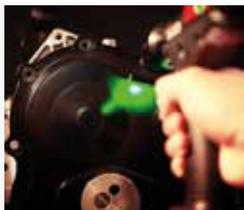
Una luce colorata segnala OK/NOK direttamente sul componente
