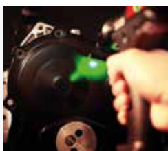
Se OK/NOK status direkt på applikation med indikator-LEDs
