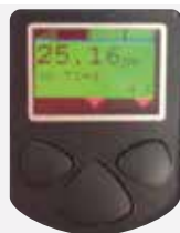
Åtdragningsresultat på OLED-Skärmen
