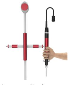
Les vis sont prélevées manuellement par le tube à vide et placées au point de vissage
