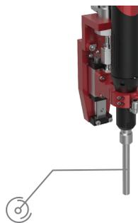
Schrauben werden von einer Vakuümhülse automatisch angesaugt und an die Schraubstelle geführt
