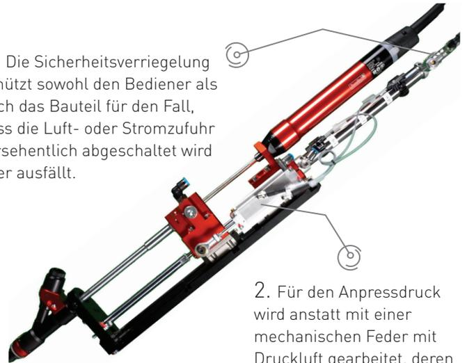
2. Für den Anpressdruck wird anstatt mit einer mechanischen Feder mit Druckluft gearbeitet, deren Luftdruck einstellbar ist. Dadurch ist der Anpressdruck variabel, was das Bauteil des Kunden schützt.
