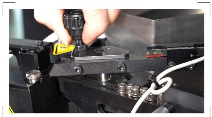
Drehen Sie den Knopf und heben Sie einfach den oberen Teil der Schiene an.
