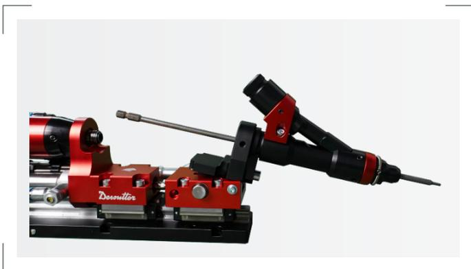
Entriegeln Sie den Bit und schwenken Sie den Zuführkopf, um den Bit zu wechseln.
