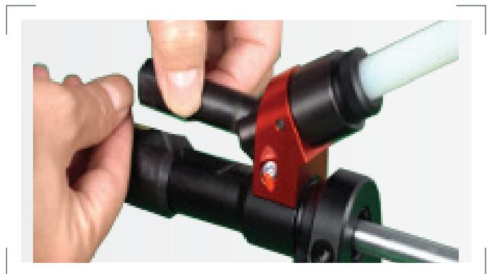
Heben Sie den Schwenkarm an, um einen Schraubenstau zu beseitigen.
