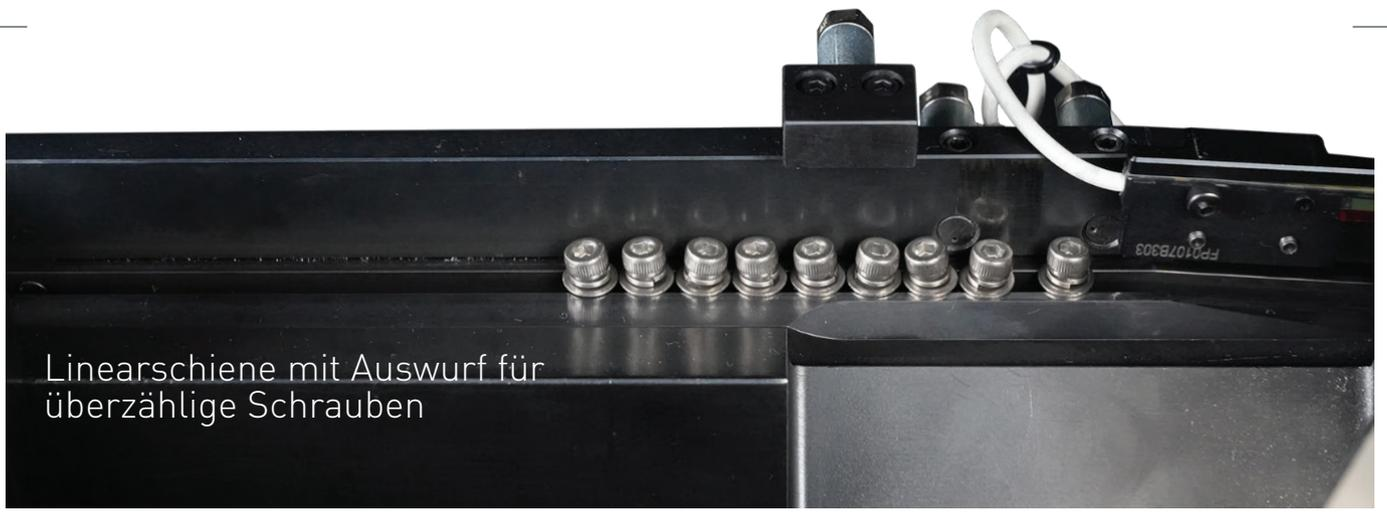
Linearschiene mit Auswurf für überzählige Schrauben
